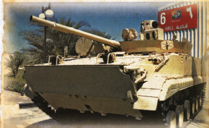
Боевая машина пехоты БМП-3 на выставке в Абу-Даби, 1999 год. Машина оснащена системой активной защиты «Арена-Э».
