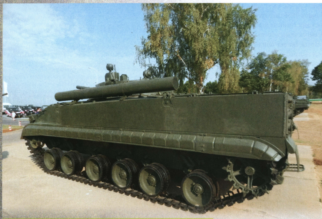
БМП-3, вид с левого борта. Хорошо видно крепление бревна для самовытаскивания.
