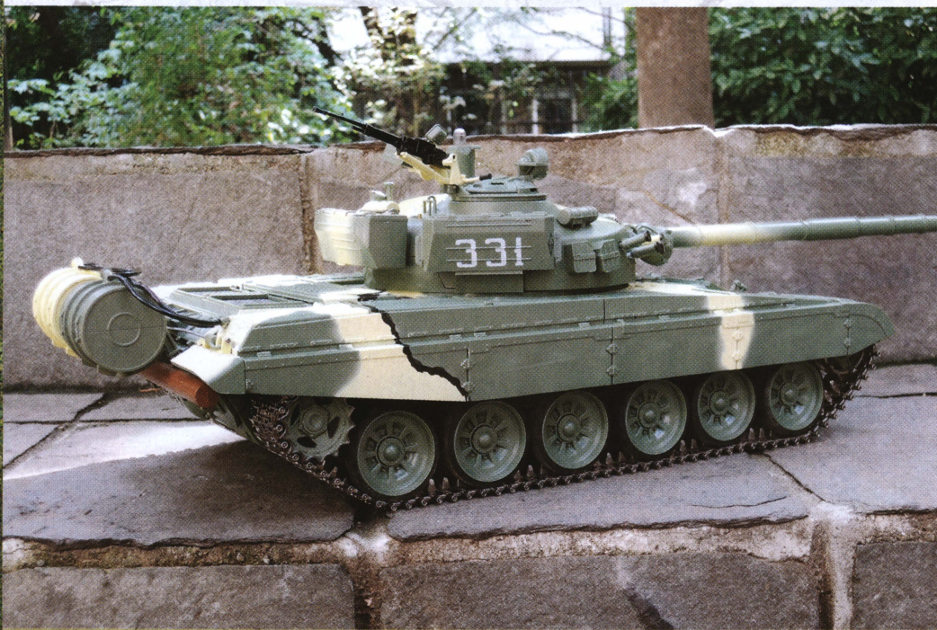
Радиоуправляемая модель танка Т-72, вид сбоку. Подвеска танка — индивидуальная, с торсионными валами полной длины (от борта до борта).
